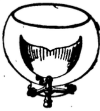
Abb. 1. Erster Brennerstyp (Schnittbrenner) 1825.
